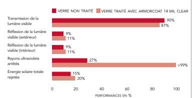
Les résultats refletent une installation à l'intérieur d'un simple vitrage transparent de 4 mm d'épaisseur et d'un double vitrage transparent de 4mm+4mm.
